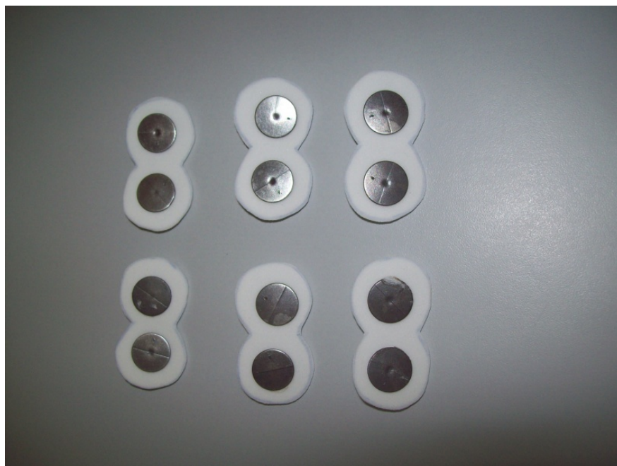
Figura 8: Eletrodos de cloreto de prata
