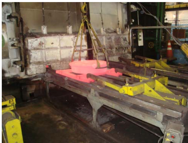
Fig. 01 – Entrada da roda no forno de austenitização.
