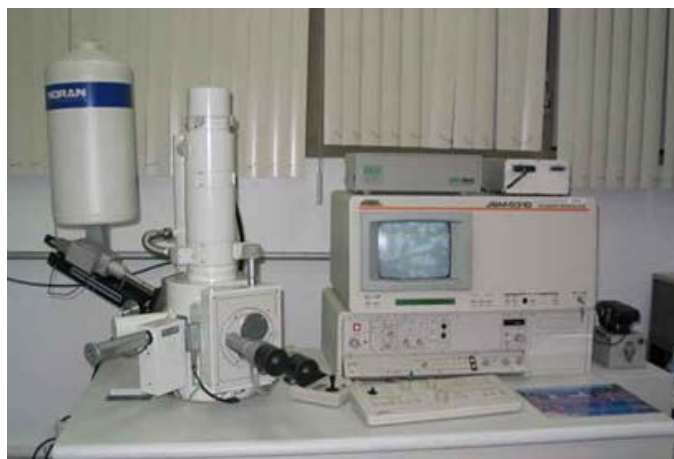
Figura 16 – Microscópio eletrônico de varredura JEOL com capacidade de análise de energia dispersiva por raios-X (Fonte: TOLEDO, 2009).
