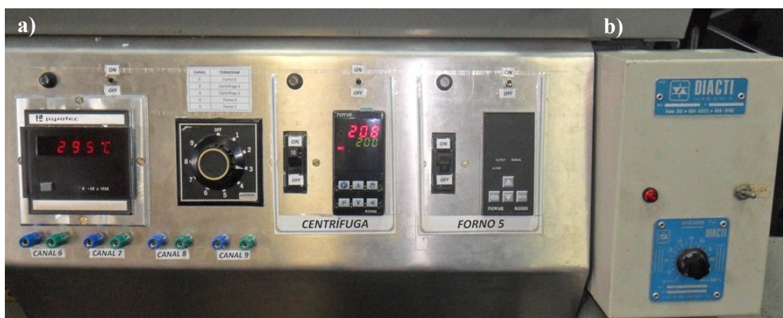
Figura 12 – a) Painel de controle e monitoramento da temperatura; b) Caixa para controle da velocidade do motor.
