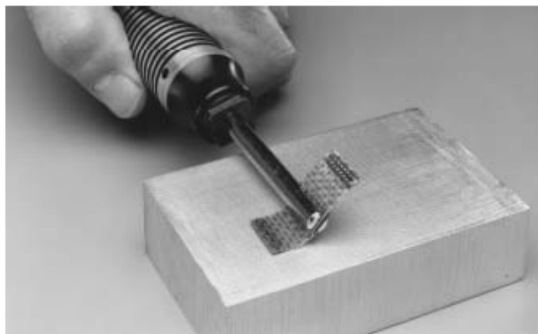
Fig.2- Ilustração do Processo de Flap Peening [8]
