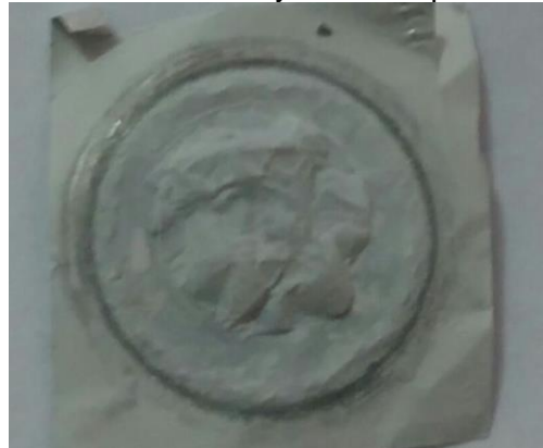
Figura 9 - Amostra PBAT/PPy com nHAp eletrodepositada na superfície
