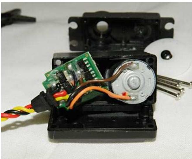
Figura 10 – Circuito de controle do servo motor [13]
