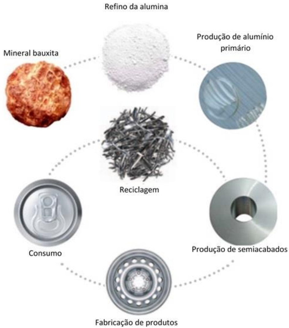
FIGURA 1 - Resumo do processo de produção do alumínio primário.
