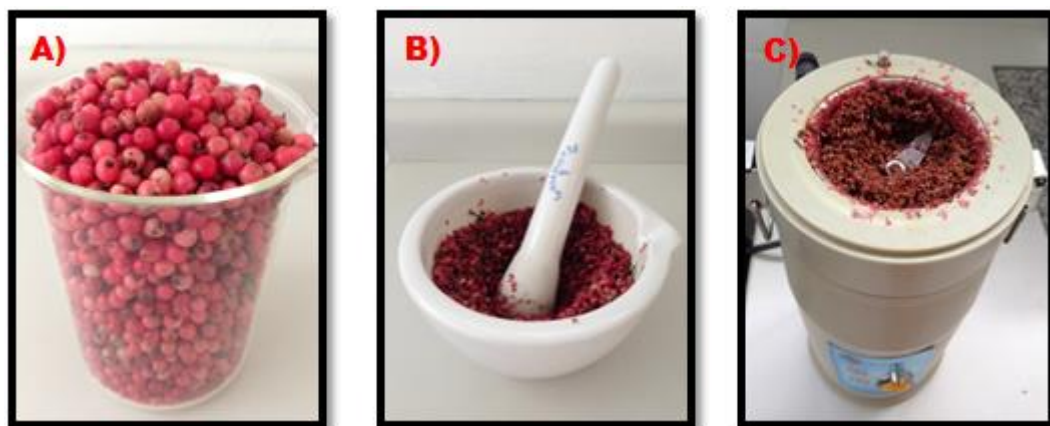
Figura 5. Extração com diferentes métodos de tratamento do fruto da pimenta rosa: A) sem maceração; B) com maceração manual; C) com maceração utilizando o moinho analítico
